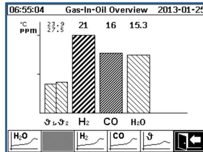
Гистограмма водорода H<sub>2</sub>, угарного газа CO, влагосодержания масла H<sub>2</sub>O (в ppm и [%]) и температуры
