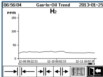
Значение измерения, в данном случае водород (H<sub>2</sub>), изображается во временной зависимости.
